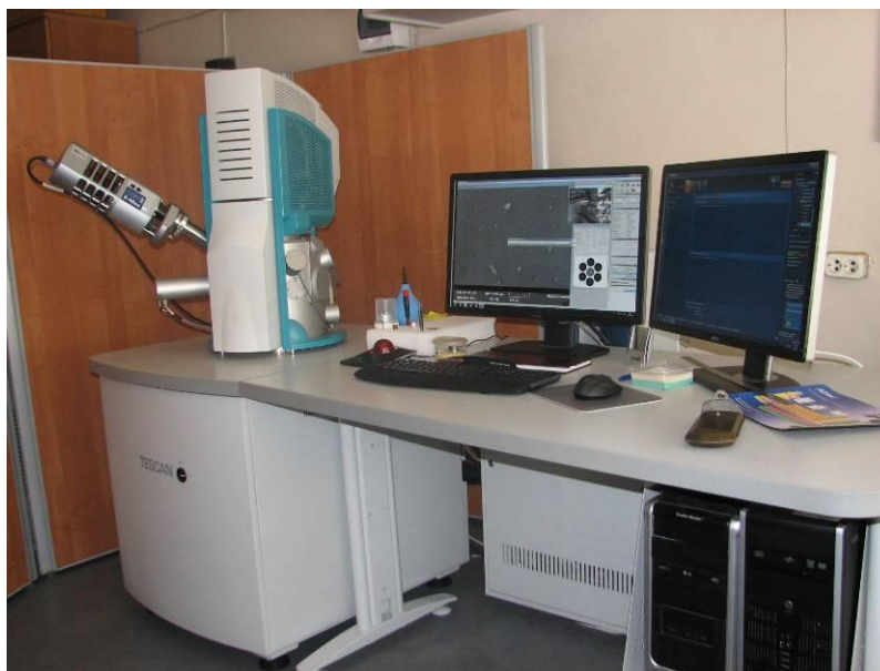
Рисунок 27 - Электронный сканирующий микроскоп TESCAN VEGA LMH с катодом LaB6 и системой рентгеновского энергодисперсионного микроанализа Oxford Instruments Advanced AZtecEnergy
