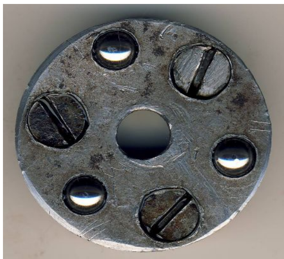
Рис. 3.17. Опорный диск с закреплёнными шарами
