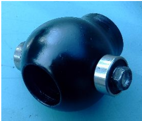
Рис. 4.27. Сферической части муфты, выполненной из капролона-42
