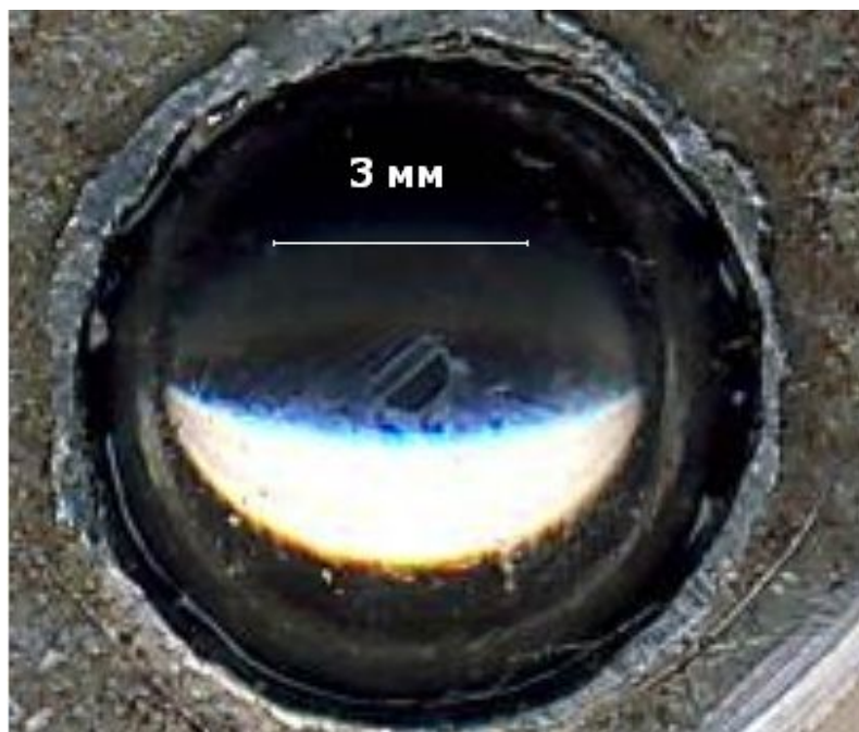
Рис. 3.18. Фотография изношенной поверхности шаров после испытаний на отработанном масле М10ДМ
