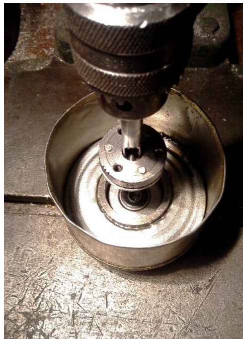
Рис. 2.16. Вид сверху на трибоузел машины трения
