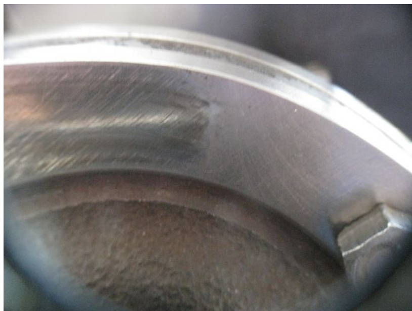
Рис. 4.13. Поверхность индентора после испытаний на углепластике
