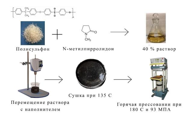
Рисунок 12. Схема приготовления раствора полимера и композитов на основе полисульфона
