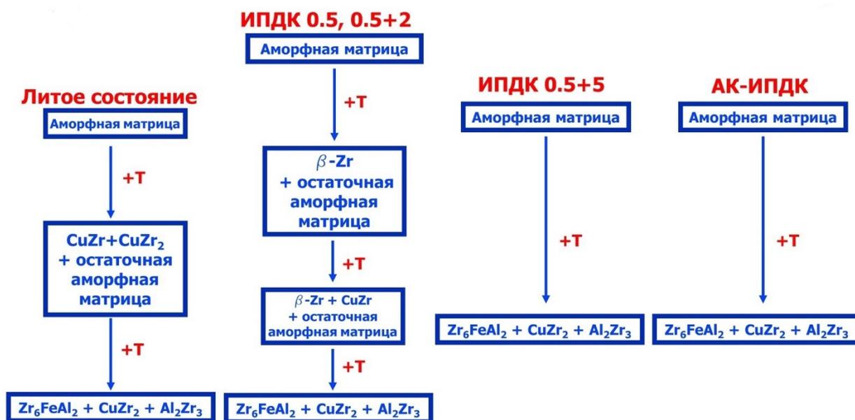
Рисунок 20 – Схематичное изображение процесса кристаллизации при нагреве сплава  $Zr_{62.5}Cu_{22.5}Al_{10}Fe_5$  в литом и деформированном ИПДК и АК-ИПДК состояниях
