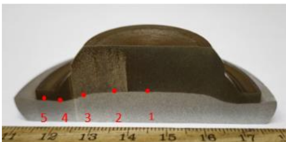
Рисунок 5.20 – Схема исследования микротвердости вблизи границы контакта составного изделия из PC-356 и BT1-0
