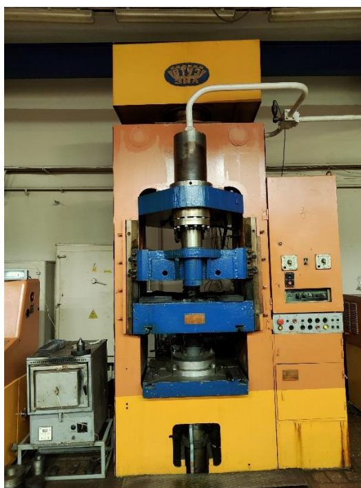
Рисунок 2.7 – Гидравлический пресс модели ДБ-2432А [58, 60, 61]
