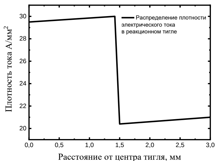
Рисунок 31 – Распределение плотности электрического тока в импульсном режиме в реакционном тигле при высоте нагревателей h = 1 \text{ мм} , диаметр реакционной зоны 6 мм
