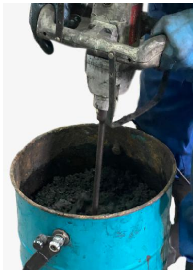
Рисунок 44 – Процесс приготовления почвогрунта с помощью турбинной мешалки
