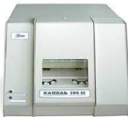
Рисунок 2.4 – Система капиллярного электрофореза
