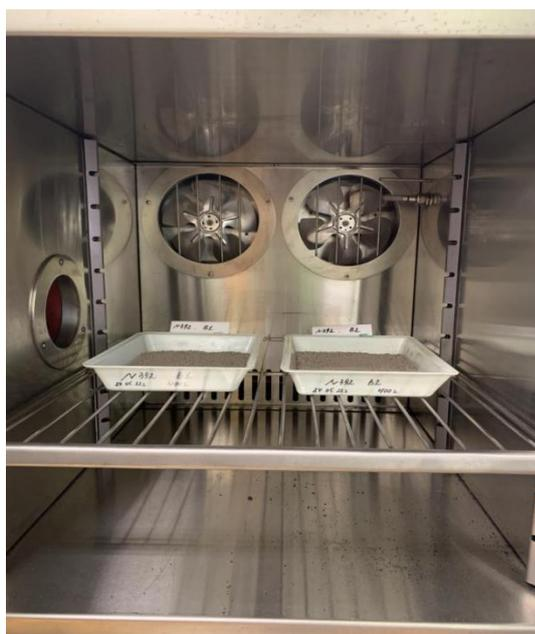
Рисунок 4.2 – Размещение проб внутри испытательной камеры «КТХВ-150»
