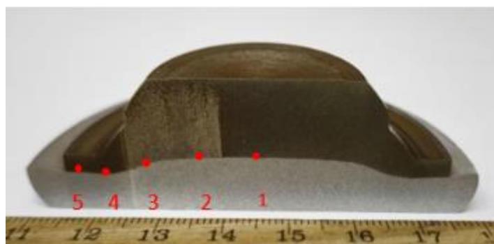
Рисунок 22 – Схема исследования микротвердости вблизи границы контакта составного изделия из PC-356 и BT1-0
