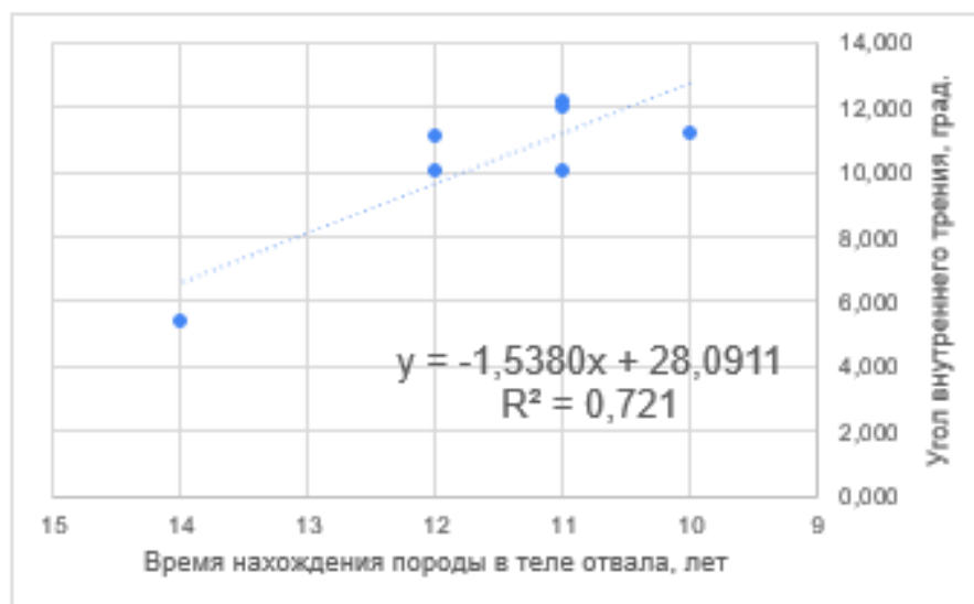
Рисунок 21 – Пример полученной зависимости показателя угла внутреннего трения от времени нахождения в техногенном массиве для содержания глинистых пород 60-80%
