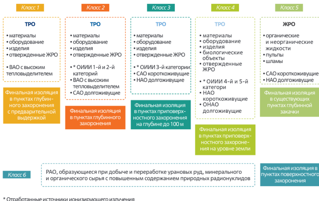
Рисунок 1.1 – Классификация радиоактивных отходов по степени опасности в соответствии с Постановлением Правительства РФ от 19.10.2012 № 1069.
