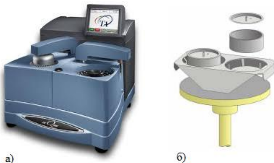
Рисунок 28 – Установка ДСК: а) внешний вид “Q20”; б) измерительные ячейки
