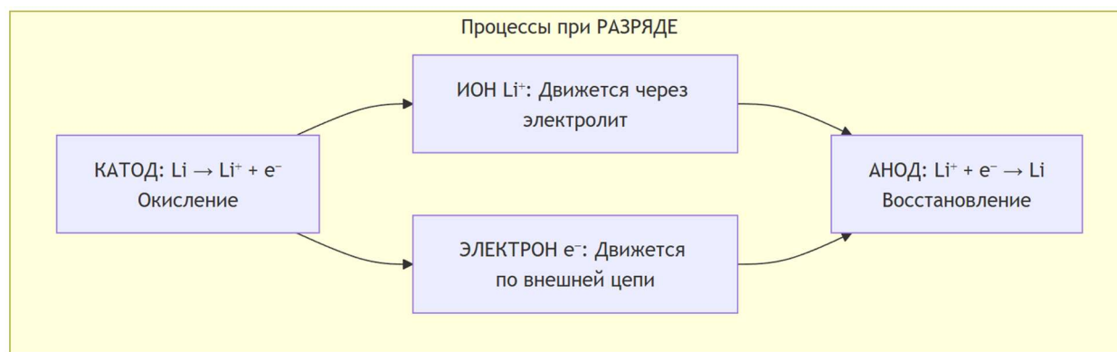
Рисунок 10. Схема разряда литий-ионного аккумулятора
