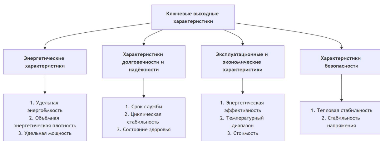
Рисунок 13. Ключевые выходные характеристики Li-ion аккумулятора.
